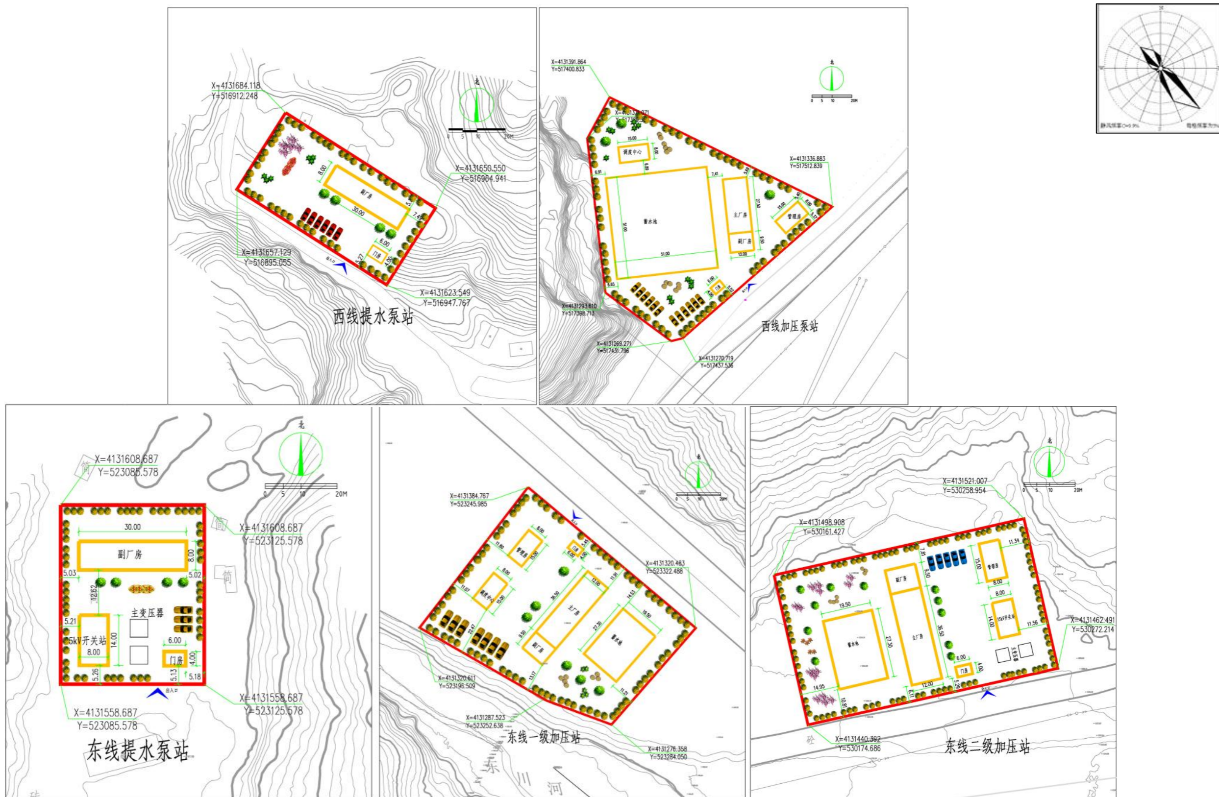
附图5 提水泵站、加压站平面布置
